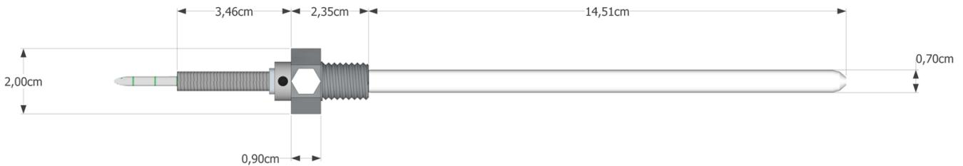
Thermofühler Typ K oder auch Flammentemperaturfühler. Die Keramikhülse hat eine hohe Temperaturbeständigkeit (1600°C), schützt somit den Fühler und verleiht ihm eine lange Lebensdauer.
