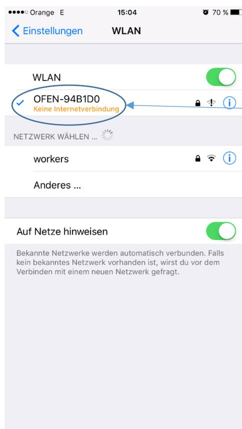
Beim direkten Anschluss mit der Steuerung hat das Handy/Tablet keine Internetverbindung.
