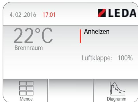
Abb. 7.13 Hauptanzeige bei geschlossener Feuerraumtür
