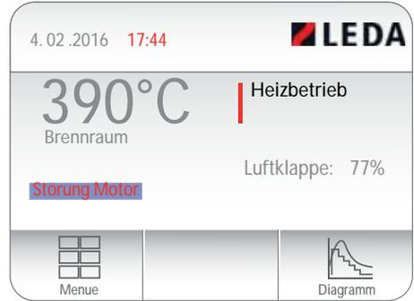
Abb. 4.3 Displayeinheit, Fehlermeldung Störung Motor
