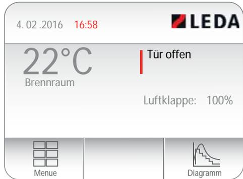
Abb. 7.12 Hauptanzeige bei geöffneter Feuerraumtür
