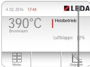
Neben der Hauptanzeige stehen alternative Anzeigen zur Verfügung. Durch Antippen des LEDA-Logos (oben rechts) erreichen Sie die alternativen Anzeigen.
