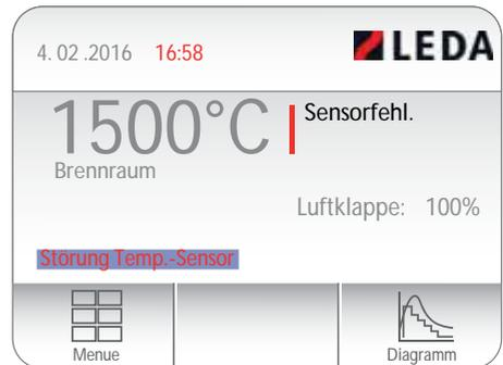
Abb. 4.4 Displayeinheit, Fehlermeldung Störung Temperatur-Sensor
