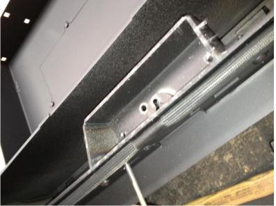
5. Bei Eckgeräten muss die Verbindung von Türkontakt und Gegenstück vom Abbrechblech entfernt werden.
