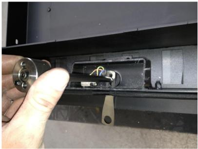
10. Innere Welle für Elektronische Steuerungen nun durch Hebel, Distanzscheibe und Äußere Welle führen.
