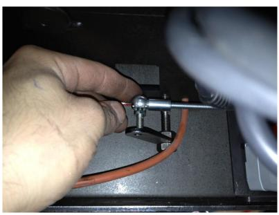
19. Kugelkopf des Motors am Verbindungsblech so montieren, dass weiterhin die Gängigkeit des Hebels gegeben ist und der Luftschieber vollständig geöffnet ist.
