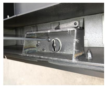
2. Demontage (Schrauben) der Türkontaktleitungsdurchführung
