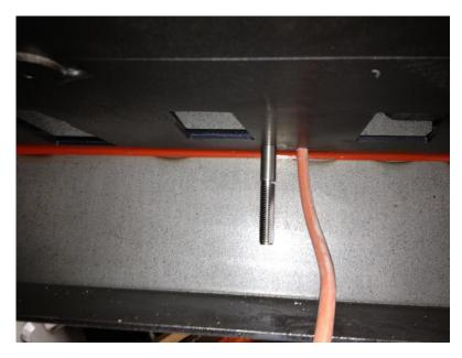
14. Durch denFeuerraumboden werdenMotor undVerbindungsblech montiert.
