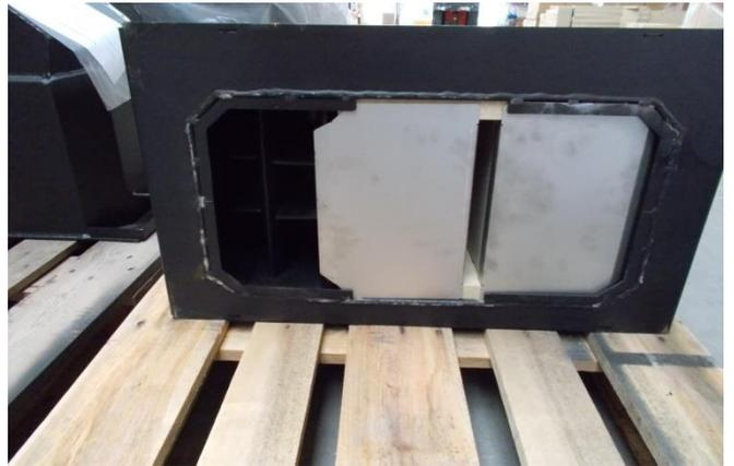
Danach werden die Zwischenräume mit der Reinigungsbürste von Ruß und Verschmutzung befreit. Dafür öffnen Sie die Feuerraumtüre und schieben das rechte untere Blech (siehe Bild) nach links und reinigen anschließend die rechten beiden Zwischenräume, der Ruß fällt nach unten in den Brennraum und kann anschließend mit einem Staubsauger entfernt werden.
