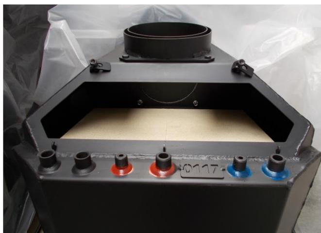
Zuerst wird der Deckel abmontiert. Dies erfolgt durch lösen der beiden oberen Muttern (Schlüsselweite 13).
