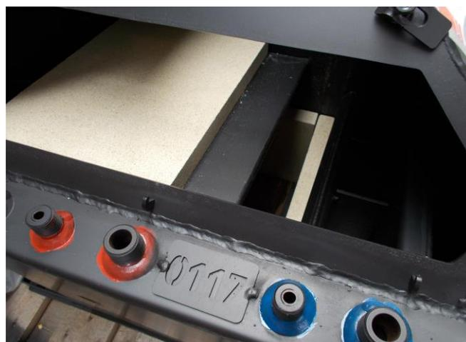
Anschließend die beiden Umlenkplatten heraus nehmen.
